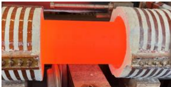
Bild 1: Stab in der Einzelstabvergütungsanlage
