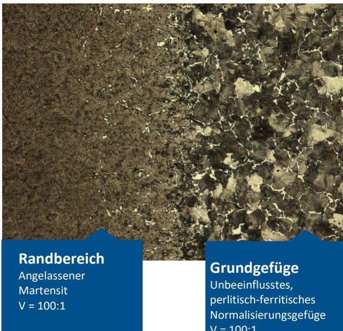
Bild 3: Übersicht & Mikrostruktur Querschliff Cf53+N+iRSH
