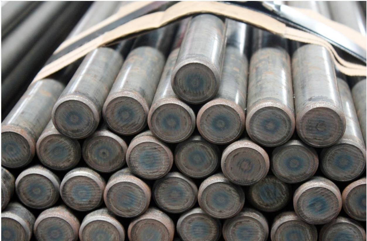
Bild 4: Randschichtgehärtetes Material vor der weiteren Veredelung
